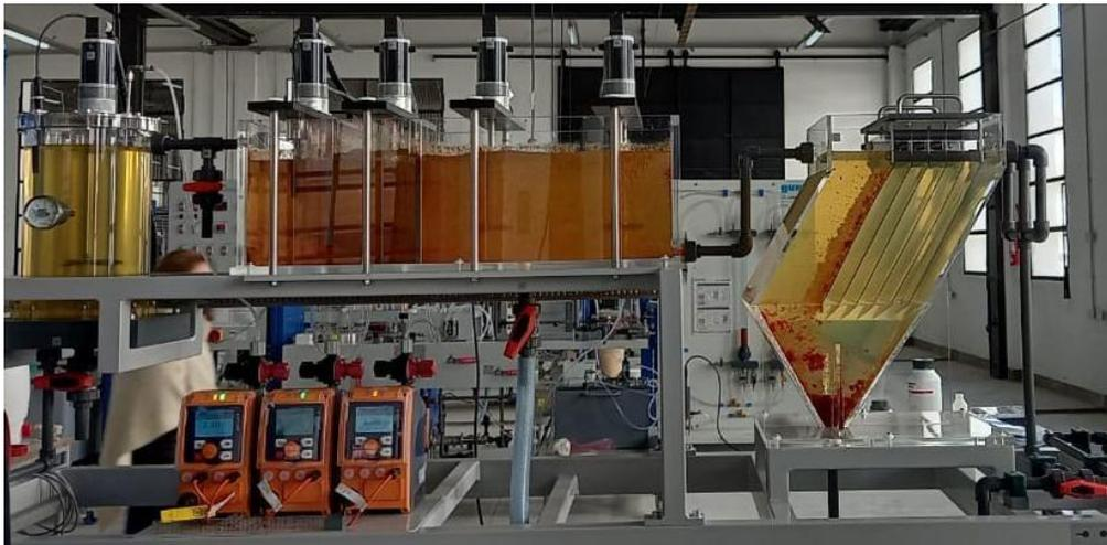
**Figura 3.** Banco de ensayos utilizado para la remoción de hierro. *De izquierda a derecha:* tanque de precipitación, unidad de coagulación-floculación y sedimentador lamelar.
