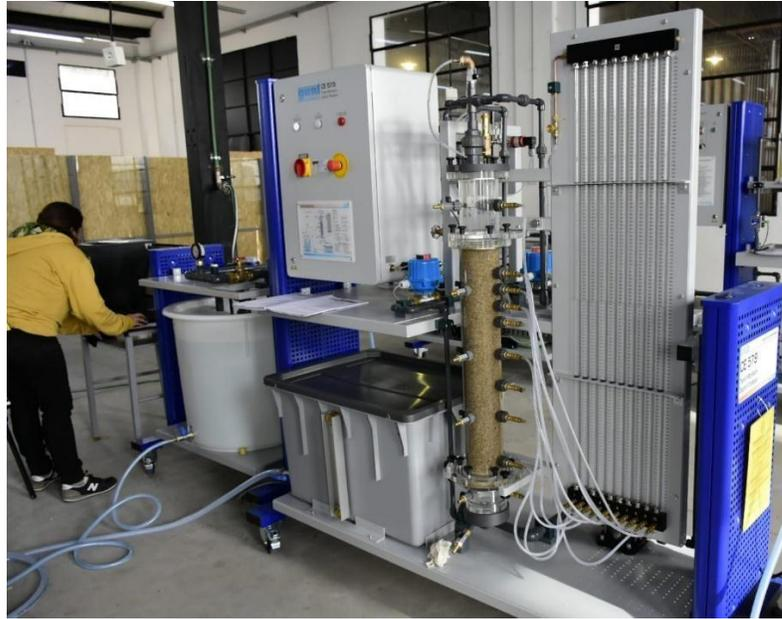
**Figura 9.** Equipo para el estudio de procesos de filtración de lecho profundo.
