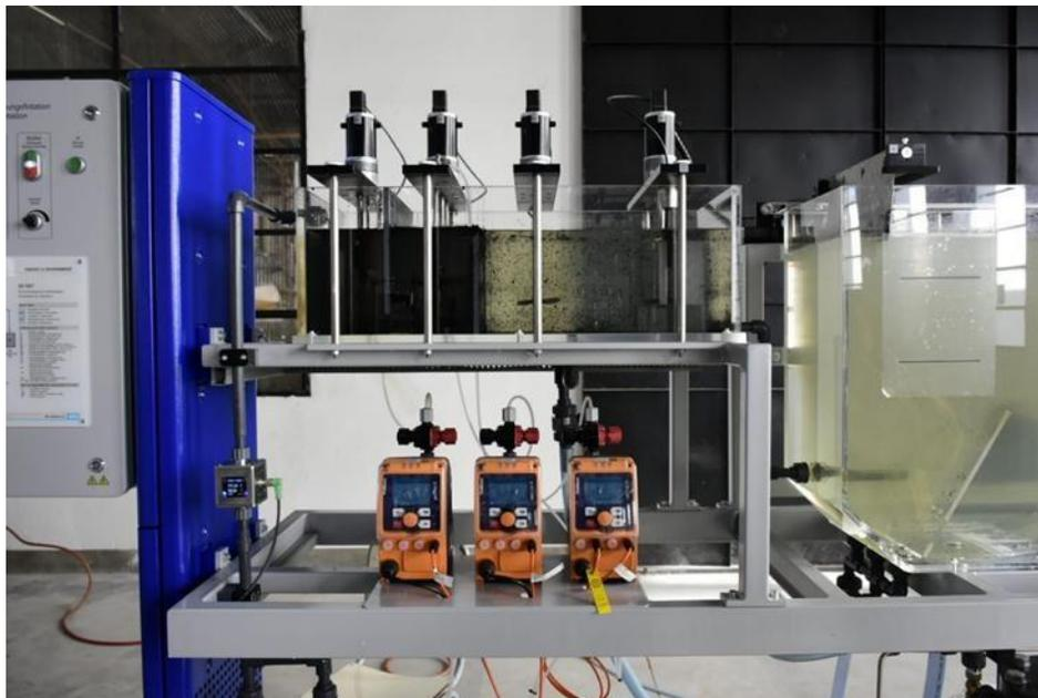
**Figura 10.** Planta de flotación por aire disuelto utilizada para la remoción de partículas de carbón activado.
