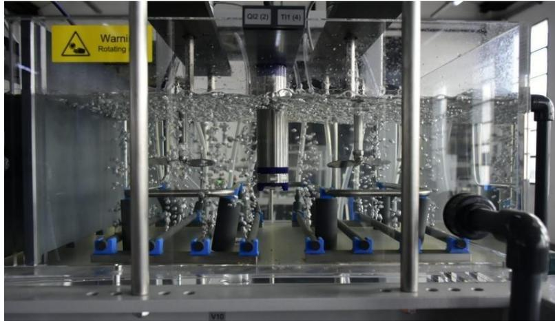
**Figura 8.** Tanque de aireación con control de temperatura y contenido de oxígeno en planta de tratamiento de lodos activados.
