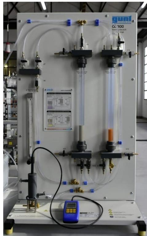
**Figura 4.** Intercambio iónico. *Arriba:* bomba de alimentación y depósito de soluciones. *Derecha:* banco de ensayos.
