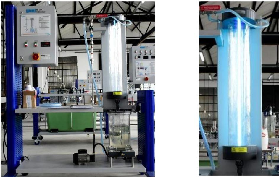
**Figura 2.** Equipo de oxidación avanzada. *Izquierda:* equipo completo. *Derecha:* lámpara de luz ultravioleta.
