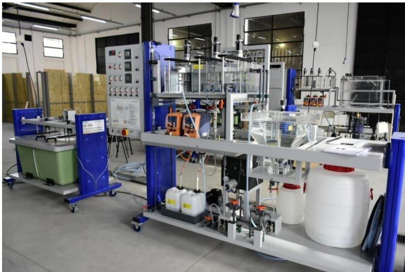
**Figura 7.** Planta de tratamiento de lodos activados.
