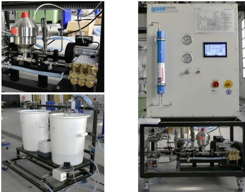
**Figura 1.** Planta de ósmosis inversa. *Izquierda, arriba:* motor, bomba y amortiguador de pulsaciones; *abajo:* unidad de preparación y disposición de soluciones. *Derecha:* membrana y panel de comandos.
